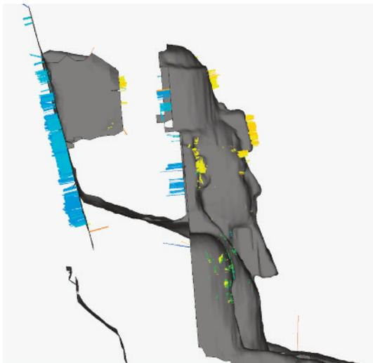
14. Confronto geometrico del modello di riferimento e nuvola di punti densa. Grafico delle deviazioni, vista laterale.
